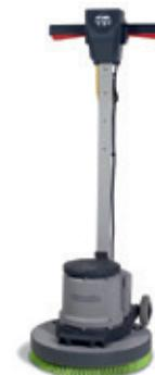
Klassische und leistungsstarke Einscheibenmaschine mit 150 U/Min. · Antriebsleistung und hoher Laufruhe · Wartungsfreies und zuverlässiges Planetengetriebe · Ideal für: Schrubben, Scheuern, Shampooieren, Schleifen etc. · Das Bürstendeck ist äußerst stabil durch die Structofoam-Bauweise · Abmessungen: 1.185 x 580 x 450 mm
