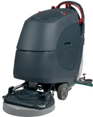
Die Scheuersaugmaschine TGB6055/100T ist für eine wirtschaftliche Unterhaltsreinigung und für die Sonderreinigung geeignet. Die Maschine ist mit einer übergangslosen Geschwindigkeitsregelung für den Vor- und Rückwärtsantrieb ausgerüstet. Die wartungsfreien, serienmäßigen 100 Ah-Gel-Batterien mit integriertem Ladegerät gewährleisten eine Laufzeit von ca. 2 Stunden. Die Maschine ist mit einem klappbaren Bürstenkopf und einem anwenderfreundlichen Bediener-Cockpit ausgestattet.
