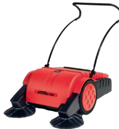
Leichtgängige Handkehrsaugmaschine mit Tandem-Walzen-System und 2 Seitenbesen für die professionelle Anwendung inklusive elektrischen Bürstenantrieb und Staubabsaugung mit 12 V / 35 Ah Batterie und onboard Ladegerät · Auch auf Teppichböden einsetzbar! Arbeitsbreite: ohne Seitenbesen 500 mm, mit 2 Seitenbesen 900 mm · Farbe: Rot RAL 2002
